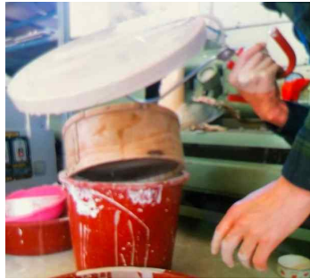
〈그림 90〉-시유 집계로 그릇을 들어올리는 사진
