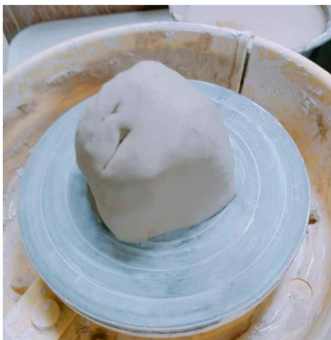
〈그림 14〉-고정한 흙을 언덕모양으로 만드는 사진
